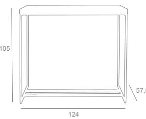
La mesa Cube se fabrica con estructura de acero en tubo rectangular, que puede ser terminada en baño de níquel o pintura epoxi. El tablero se realiza en madera de haya atamborada de 5 cms. Es posible fabricar el tablero en diferentes grosores y maderas naturales.
